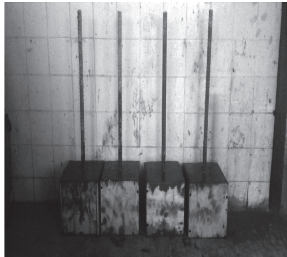
Fotografía 9. Probetas prueba de adherencia
