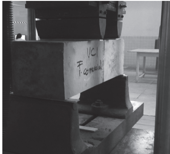
Fotografía 7. Ensayo a flexión en vigas
