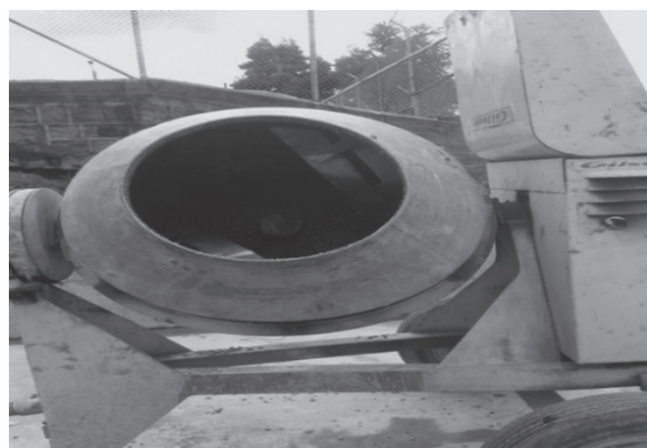
Figura 3. Fabricación del hormigón ligero.
