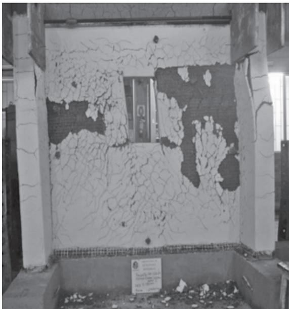
**Figura 11.** Ensayos en muros reforzados con geomalla [16].
