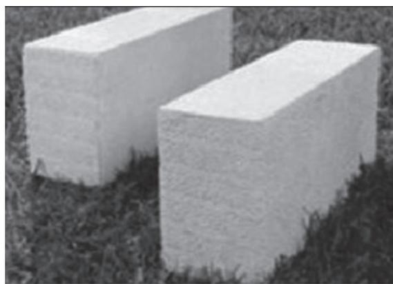
**Figura 3.** Concreto celular o aireado
