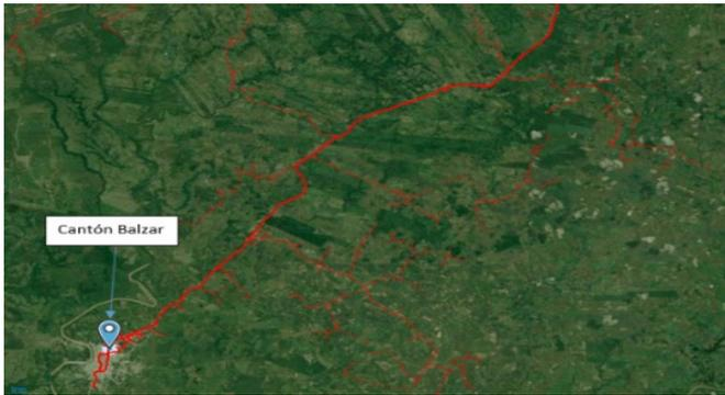
plazo del alimentador de media tensión La Guayaquil de la subestación de distribución 69/13,8 kv Balzar, la cual tiene una longitud total de 30 km de troncal con configuración radial. La misma está conformada con varios calibres de conductor de aluminio desnudo con calibres ACSR 266, 8; 4/0; 1/0 y # 2. El alimentador tiene un total de 242,86 km de línea que entregan energía eléctrica a 3358 abonados del cantón Balzar.
