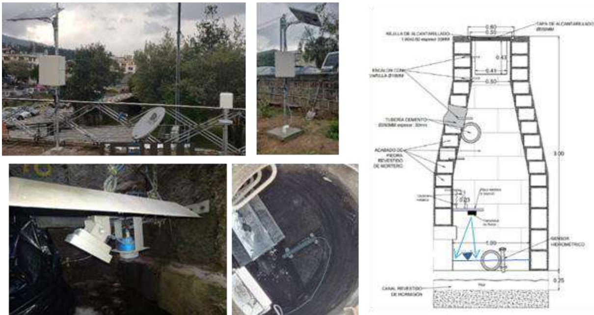
Nota. Sensores de medición de velocidades y calados del flujo y pluviómetro.
