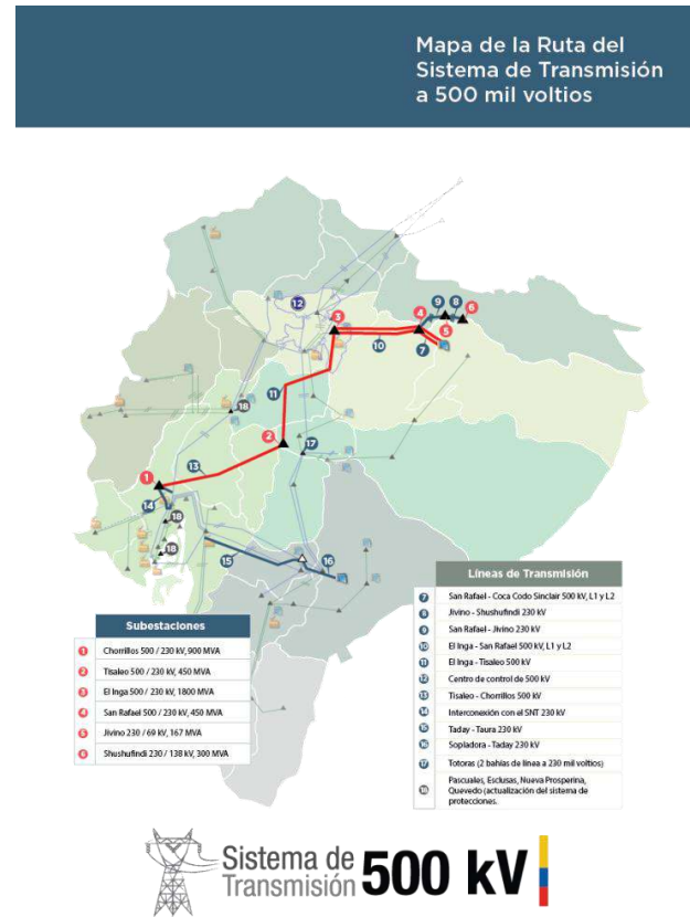
Figura 2. Sistema de transmisión de 500KV
