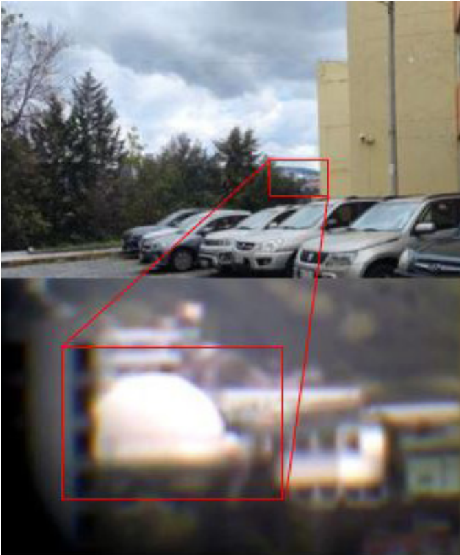
Figura 8. Comparación del sistema de captura digital. Arriba: imagen sin aumento de un planetario ubicado a 2,2 km (capturada con teléfono celular). Abajo: la misma estructura observada a través del telescopio diseñado, donde se distingue la cúpula con bajo nivel de detalle y presencia de aberración cromática.
