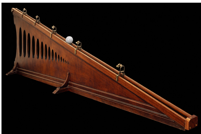
Figura 5. El Plano de Galileo es un plano inclinado que permitía medir distancias y tiempo de un cuerpo que se desliza por acción de la gravedad. En la imagen se puede observar que hay campanillas colocadas a distancias que aumentan de forma aritmética. Cuando se deja caer una esfera esta hace sonar las campanillas en intervalos constantes lo que significa que la distancia recorrida aumenta con el tiempo de forma cuadrada (Museo Galileo, 2010). Experimentos como estos permitieron a Galileo determinar leyes físicas consolidando lo que hoy llamamos método científico.
