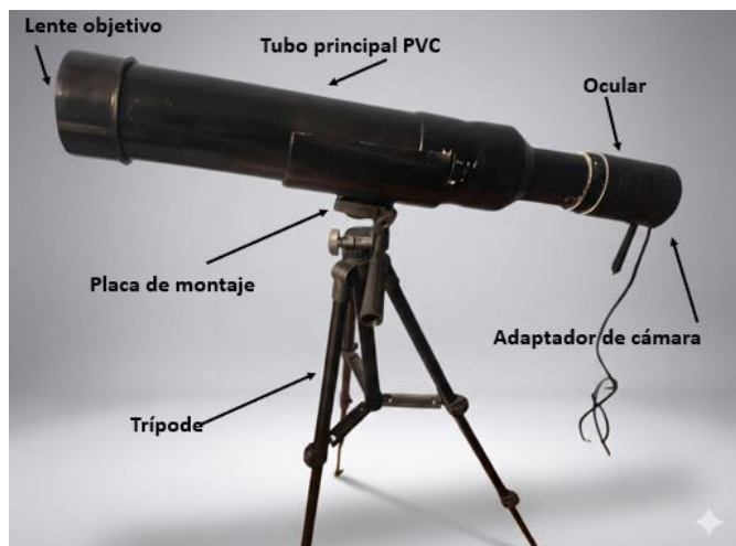
Figura 5. Telescopio kepleriano terminado. Se distingue el lente objetivo frontal, el tubo principal de PVC, el tubo deslizante para el enfoque y el ocular en el extremo posterior. Sobre el tubo se aprecia la placa de montaje para fijarlo a un trípode, mientras que en la parte final se observa el adaptador que permite acoplar una cámara web para captura digital.
