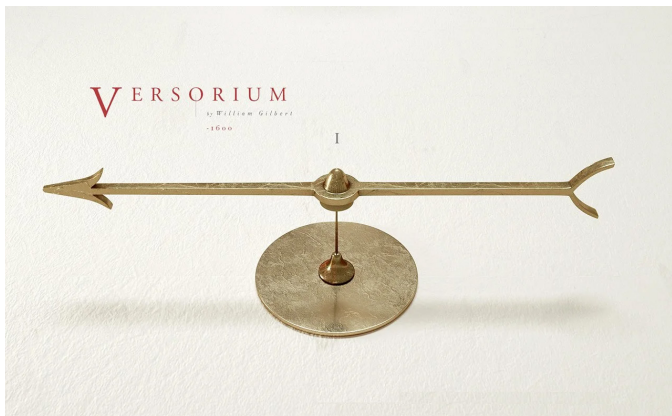
Figura 5: El versorium, creado por William Gilbert en el siglo XVI, es considerado el primer dispositivo diseñado para detectar electricidad estática. Consiste en una aguja metálica muy liviana que puede girarse libremente sobre un eje (similar a una brújula, pero sin imán). Cuando un objeto cargado eléctricamente se aproxima, la aguja gira y apunta hacia él, debido a la inducción electrostática. ( Beauty of Science , s. f.).
