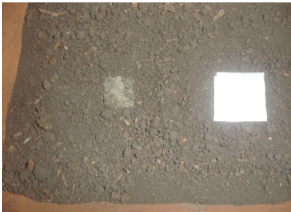
Figura 8. Tercera semana de degradación en suelo de humus. La lámina de la izquierda corresponde a la película de quitina, mientras que la lámina de la derecha corresponde a película de poliestireno.
