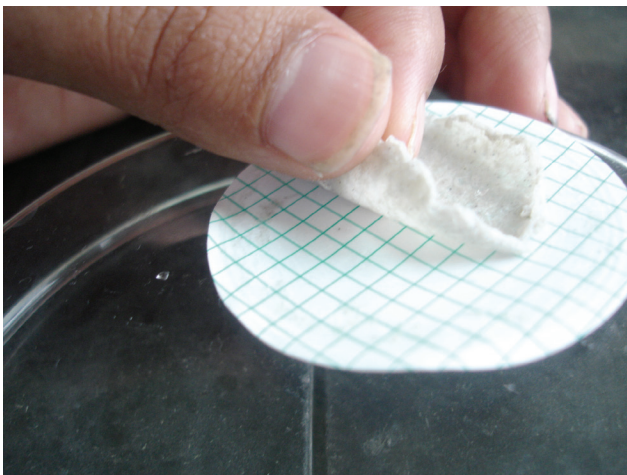
Figura 4. Formación de películas de quitina en membrana polimérica
