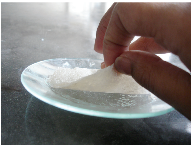
Figura 3. Formación de películas de quitina en vidrio reloj.
