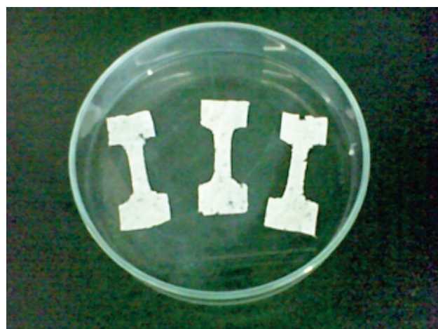
Figura 2. Probetas de esponja de quitina acondicionadas con aditivos
