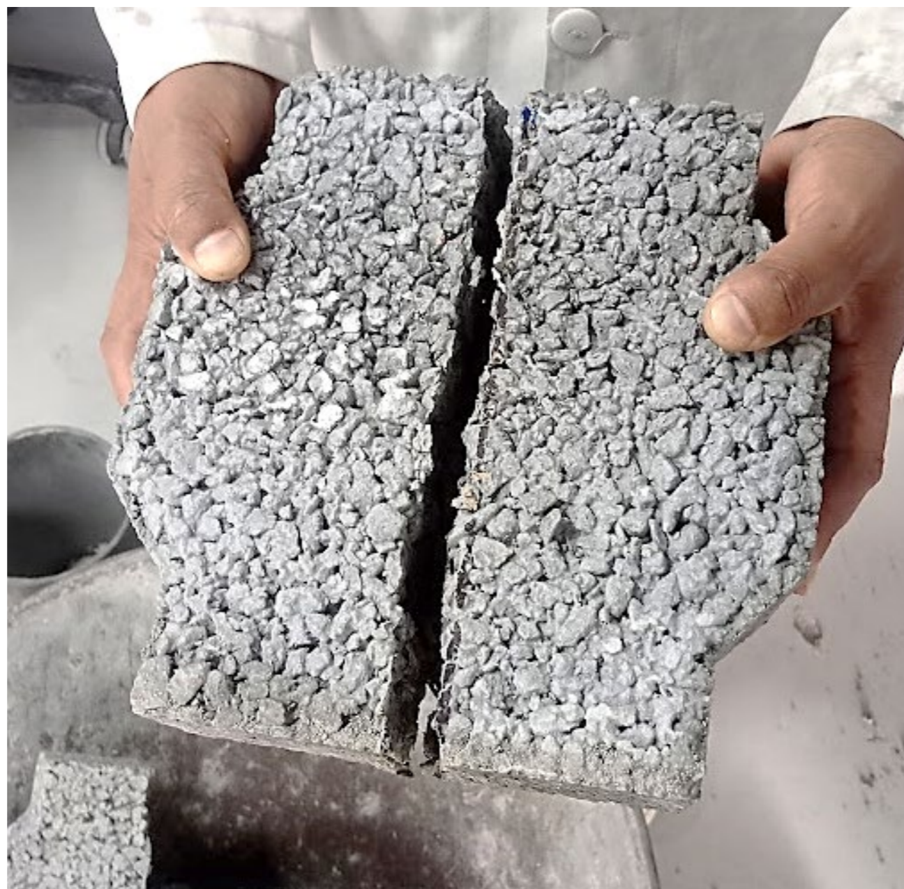
FIGURA 7 Adoquín después de la tracción indirecta
