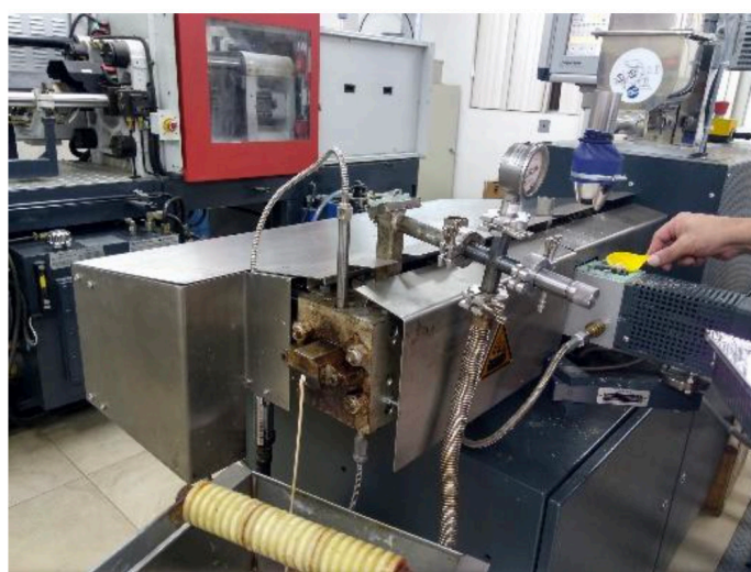
Figura 3. Proceso de Extrusión del biomaterial en máquina de extrusión de doble tornillo para termoplásticos de marca Coperion-serie ZSK18ML
