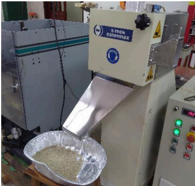
Figura 5. Obtención de granza, máquina de peletizado K-tron Colormax Systems
