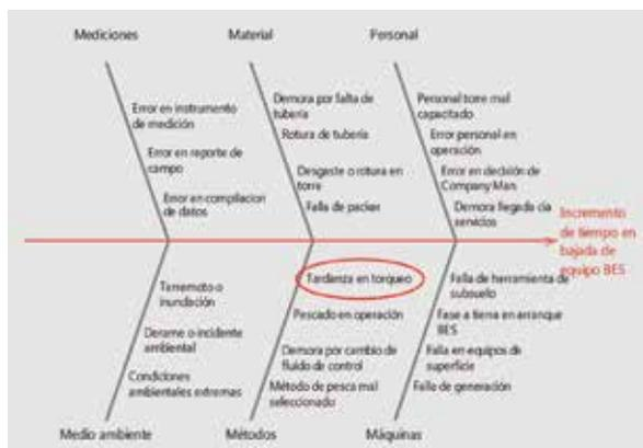
Figura 9. Diagrama causa-efecto para falla en bajada de BES
