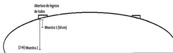
Figura 4. Esquema de muestreo en el geotubo
