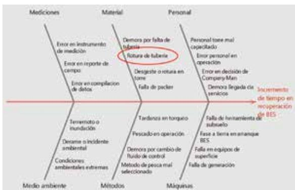
Figura 6. Diagrama causa-efecto para falla en recuperación de BES
