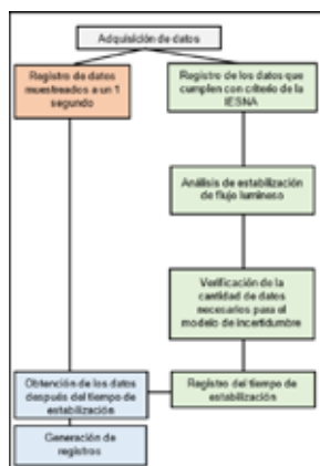
Figura 2. Esquema del proceso de adquisición de datos para el análisis de estabilidad de flujo y registro de los datos de forma automática
