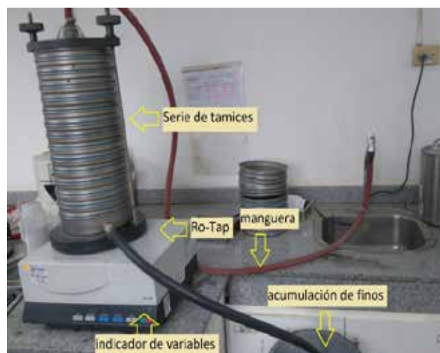
Figura 6.- Montaje del vibrotamiz para análisis granulométrico. (Fuente: Laboratorio Geocientífico INIGEMM)
