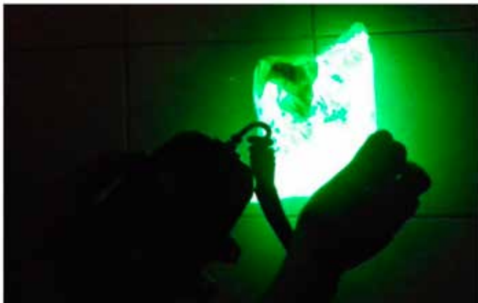
Figura 5. Medición de la intensidad lumínica del polvo de SrAl 2 O 4 :M colocada a un período de exposición a luz solar "natural" (Tiempo de exposición = 8 horas)
