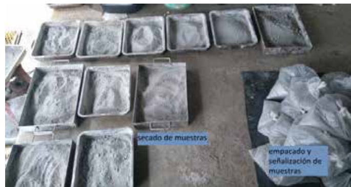
Figura 5.- Secado, empacado y codificación de las muestras de la planta de beneficio. (Elaboración propia)
