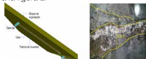
Figura 2.- Esquema del muestreo tipo canal en yacimientos vetiformes. (Elaboración propia).
