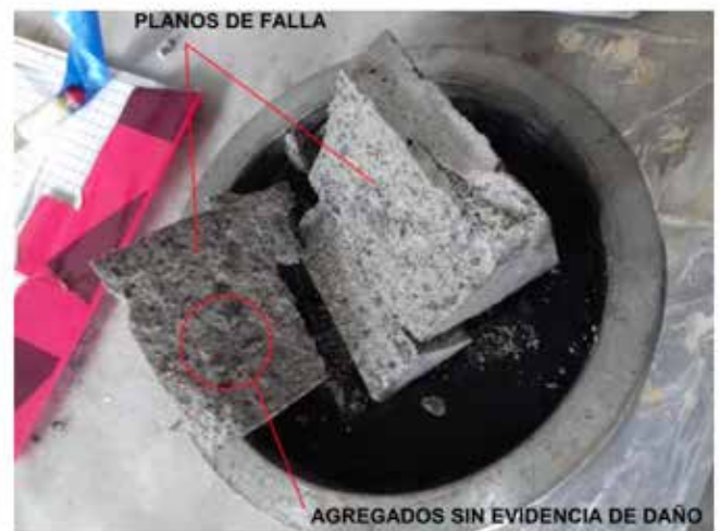
Figura 2. Fotografía de uno de los especímenes de M2 de 3 días de edad, se aprecia el modo de propagación de la grieta y la textura de la falla.
