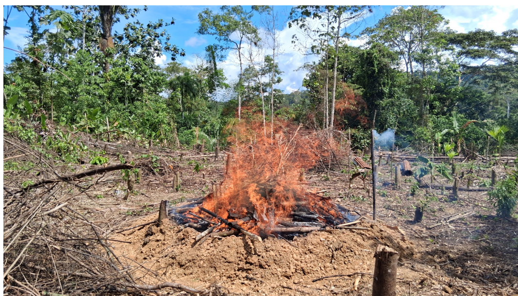
Figura 4. Pirólisis en un horno de cortina de llama. Figure 4. Pyrolysis in a flame curtain kiln.
