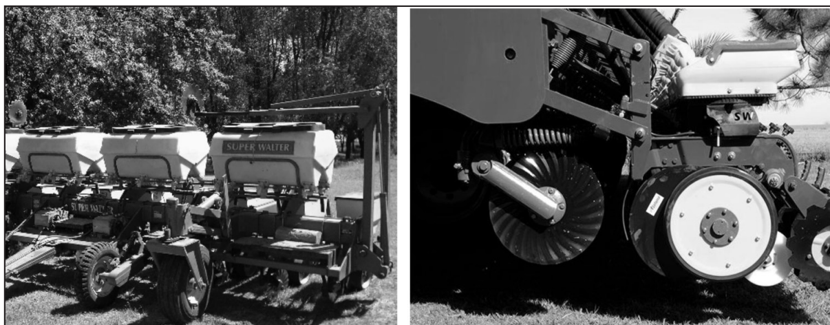
Figura 3. Sembradora 1, Super Walter y detalle del tren de siembra.
