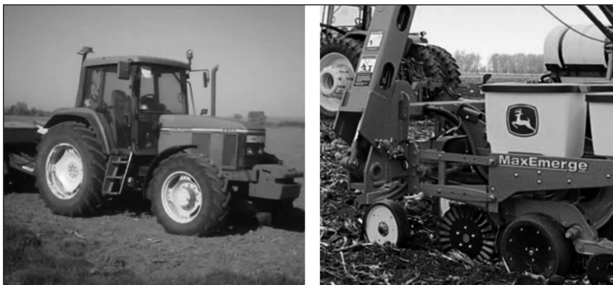
Figura 4. Tractor y sembradora 2, J. Deere 1700 Maxemerge, y detalle del tren de siembra.
