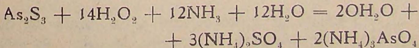
además, dicho compuesto, se disuelve en los hidratos alcalinos y en carbonato de amonio, (diferencia del estaño y antimonio), formando una mezcla de sulfoarsénito y arsenito alcalinos:
