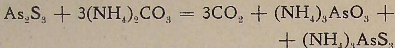
También se disuelve el trisulfuro de arsénico en el sulfuro de amonio, originando sales sulfo amónicas, descomponibles por la adición de un ácido diluido, p. ej. el clorhídrico, que precipita nuevamente trisulfuro de arsénico:
