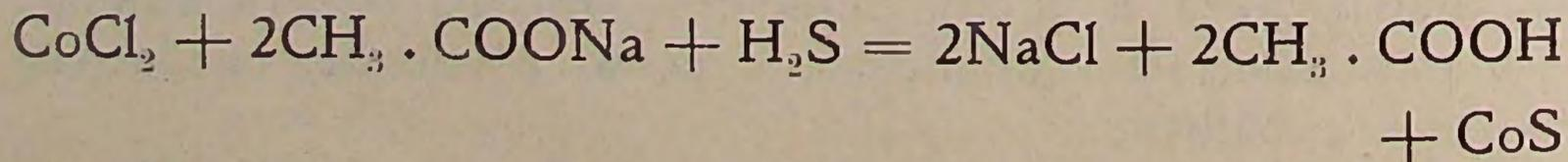
4ª. El sulfuro de amonio da un precipitado negro de sulfuro de cobalto, insoluble en el ácido acético y clorhídri-
