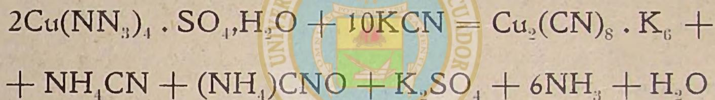
La estabilidad del ion complejo  $\text{Cu}(\text{CN})_4^{--}$  impide que sea precipitado el cobre de esta última disolución por el gas sulfhídrico, a diferencia del Cadmio.
