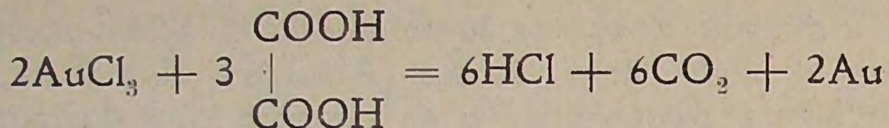
En frío la precipitación es lenta; en cambio, en caliente es rápida. La presencia de un exceso de ácido clorhídrico libre impide la reacción.
