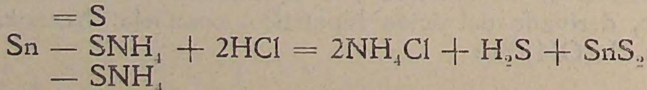
En las soluciones estánnicas, el ácido sulfhídrico, precipita sulfuro estánnico, amarillo, insoluble en ácidos diluidos, soluble en ácido clorhídrico concentrado:
