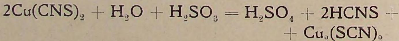
Esta reacción es muy importante en la determinación cuantitativa del cobre. El sulfocianuro cuproso es insoluble en agua y en los ácidos clorhídrico y sulfúrico diluido.
