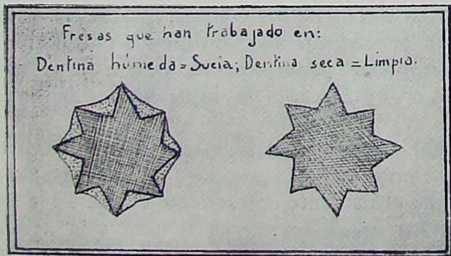
Fig. 5. Sección transversal de una fresa trabajando en campo seco y en campo húmedo. Condición que explica la necesidad de trabajar en campo seco para producir menos dolor.
