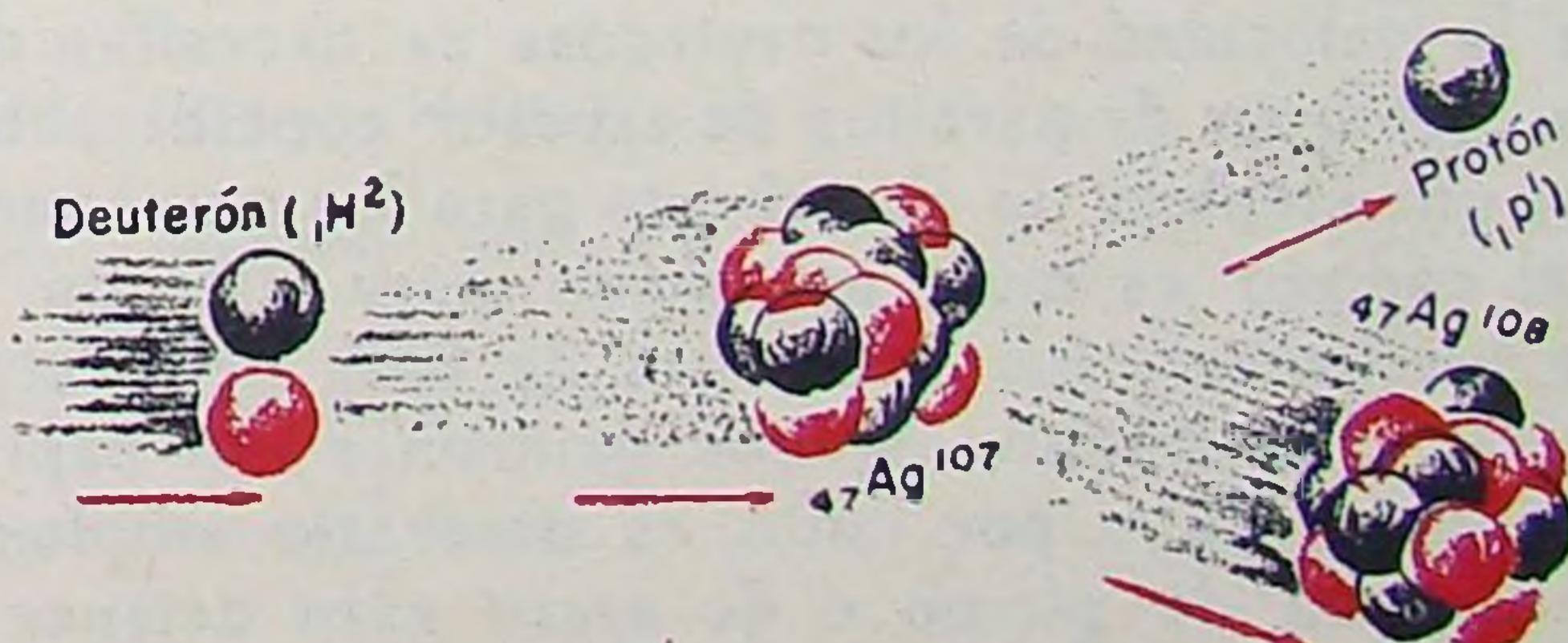
Los deuterones pueden también expeler protones. La transformación de la plata  $^{47}\text{Ag}^{107}$  en el isótopo radioactivo  $^{47}\text{Ag}^{108}$ , mediante la captación del neutrón (arriba), puede conseguirse con el bombardeo con deuterones. En este caso se expelle un protón. Como antes, el isótopo de la plata degenera en cadmio de forma estable mediante la emisión de un electrón.
