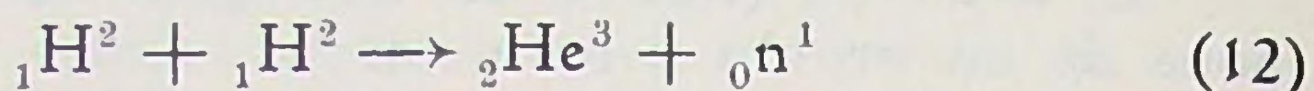
para energías pequeñas hasta de 10.000 voltios, y se utiliza como manantial prolífico de neutrones en los pequeños desintegradores de átomos que funcionan a bajo voltaje.
