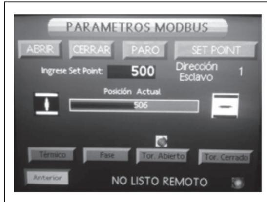
**Figura 26.** Simulación de falla de torque abierto.
