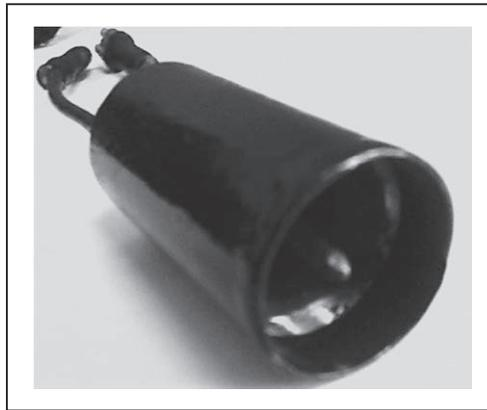
*Figura 2.* Sonda del sensor de resistencia eléctrica de suelo.
