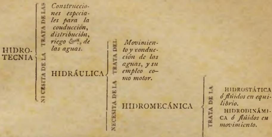
**18. Partes que comprende la Hidrotecnia.**—Esto supuesto, como el trabajo del hombre forma la industria agrícola, manufacturera ó fabril y mercantil, la Hidrotecnia debe auxiliar la producción en la mejora del terreno con fines agrícolas, ó haciendo las construcciones necesarias para el movimiento de las máquinas que se destinan á las manufacturas, ó finalmente, facilitando, por la naturaleza de los trabajos, la conducción de los objetos de comercio. Así, la Hidrotecnia trata :
