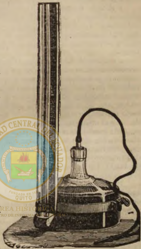
Fig. 27.—Manómetro compensador de Marey.
