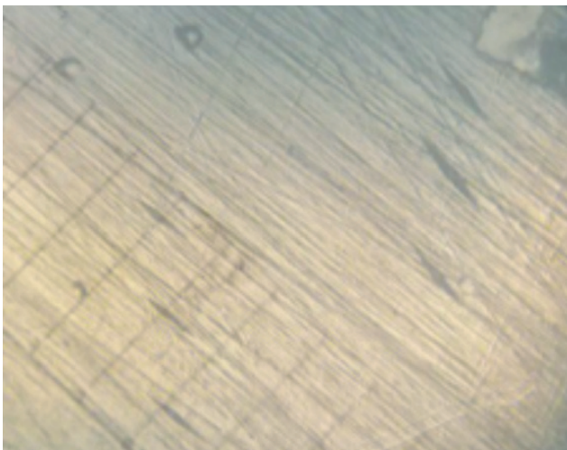
Figura 3. Microfotografía con indentaciones iniciales y post-desmineralización
