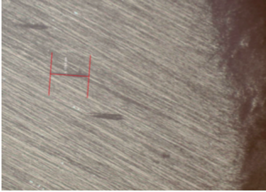
Figura N° 2. Microfotografía en la que se muestra las tres indentaciones realizadas a cada fragmento.
