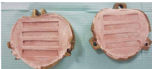
Figura 2. Patrones que dejó la cera en el yeso extraduro utilizando la técnica de la cera perdida.
