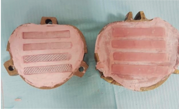
Figura 3. Polimerización en el acrílico de termo-curado
