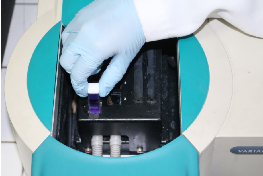
Figura 6. Colocación de la celda en el compartimento de muestras del espectrofotómetro; Placing the cell in the specimen compartment of the spectrophotometer.
