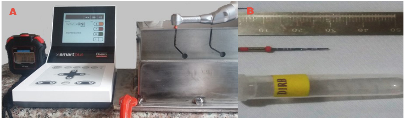
Figura 2. Sistema recíprocante accionado. A. Toma del tiempo B. Medición de la zona fracturada; Powered reciprocating system. A. Time taking B. Measurement of the fractured area
